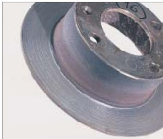
**Descrizione del difetto:** il disco è estremamente usurato ed è stato danneggiato dal supporto metallico della pastiglia, il cui materiale di attrito è completamente scomparso. Per questo disco, il cui spessore quando è nuovo è di 7 mm, lo spessore misurato è di 3,5 mm, mentre lo spessore minimo prescritto è di 5 mm.
