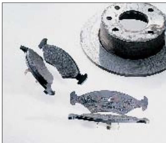
**Descrizione del difetto:** una fascia frenante di uno dei dischi è in contatto con il supporto metallico della pastiglia. Dopo l'esame delle pastiglie, si rileva una disparità di usura dovuta al bloccaggio della pinza (le pastiglie dell'altra pinza sono in perfetto stato).
