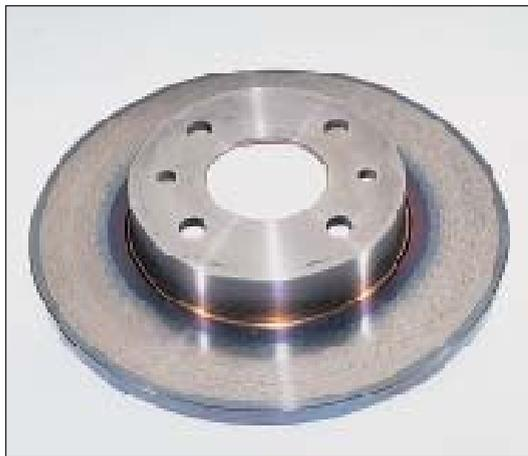
**Descrizione del difetto:** il disco presenta delle colorazioni di intensità e sfumatura variabili (blu, viola, dorato), visibili principalmente nelle zone di raffreddamento (canalino e interno della campana).
