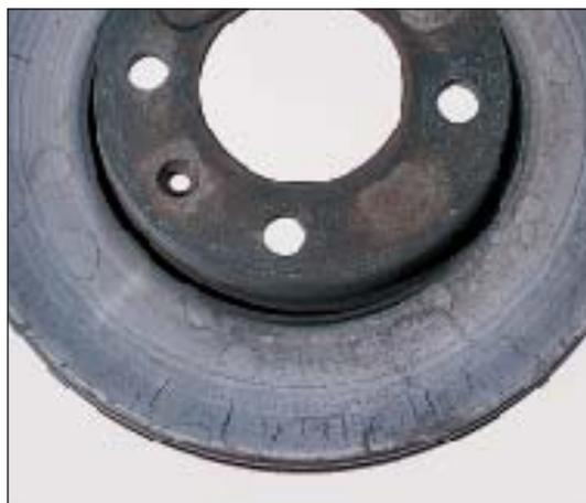
**Descrizione del difetto:** il disco è stato sottoposto a temperature di funzionamento troppo elevate: nella parte esterna della pista frenante vi sono tracce evidenti di surriscaldamento. Le alte temperature operative favoriscono la comparsa delle cricche.
