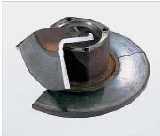
alla presenza di punti duri nel materiale di attrito, indice di una miscela male omogeneizzata. Può anche denotare un cattivo funzionamento della pinza.
