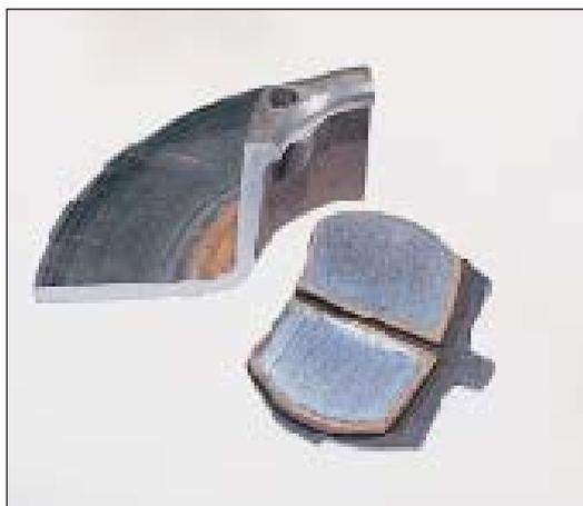
**Consigli:** controllare periodicamente l'usura del disco. Il disco deve essere sostituito ogni due o tre sostituzioni delle pastiglie.
